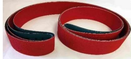
Schleifbänder mit extrem schwerer Polyesterunterlage, aggressivem Keramikkorn und Zusatzbeschichtung für einen kühlen Schliff insbesondere auf Titan, Nickelbasislegierungen und Edelstahl.
