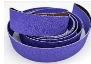
Schleifbänder mit extrem schwerer Polyesterunterlage, aggressivem Keramik Korn und Zusatzbeschichtung für einen kühlen Schliff insbesondere auf Titan, Nickelbasislegierungen und Edelstahl mit 3 bis 5 fachen Standzeiten gegenüber konventionellem Keramik Korn.
