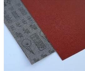
Hochflexibles Schleifband mit Aluminiumoxid Korn und Zusatzbeschichtung für einen kühlen Schliff für NE-Metalle wie Aluminium, Kupfer, Zamac und Edelstahl. Aufgrund des Polycotton Gewebes sehr dehnungsarm und kantenstabil.
